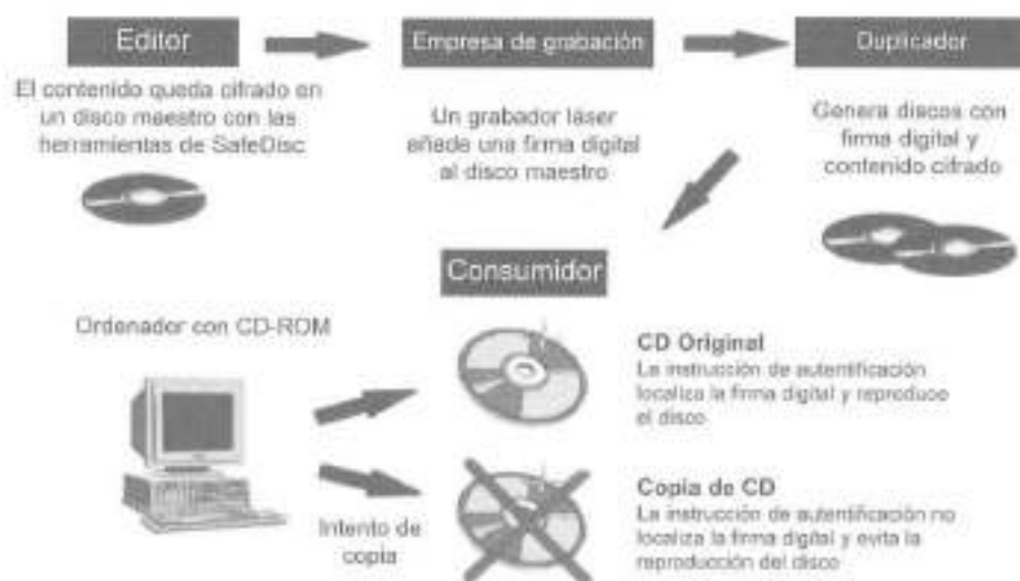
Figura 1-13. Tecnología de fabricación de CDs protegidos con SafeDisc
